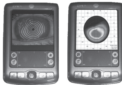
Figura 7. Telas do Palm para a captura da imagem de Plácido e resultado do mapa para um dos voluntários (com ceratocone). Figure 7. Palm-Top screens for capture of Plácido image and resulting map for a voluntary (with keratocone).
