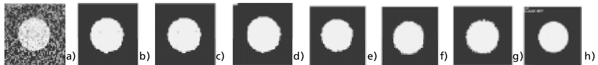
Figura 9: Resultado da segmentação para SNR=2 utilizando a) limiarização ótima; b) limiarização ótima de imagem filtrada (mediana 3x3); c) limiarização ótima de imagem filtrada (mediana 3x3) com restrição de conectividade; d) expansão do balão; e) expansão do balão sobre imagem filtrada (mediana 3x3); f) refinamento por técnica híbrida; g) refinamento por simulated annealing . h) segmentação real S^{(r)} . Figure 9: Result of the segmentation for SNR=2 using a) optimal thresholding; b) optimal thresholding over filtered image (3x3 median); c) optimal thresholding over filtered image (3x3 median) with restriction of connectivity; d) balloon expansion; e) balloon expansion over a filtered image (3x3 median); f) hybrid technique refinement; g) refinement using simulated annealing. h) real segmentation S^{(r)} .
